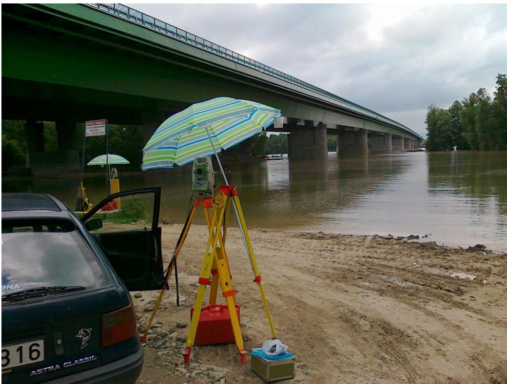
3-1 Leica TPS 1201 típusú robot mérőállomások mérés közben
