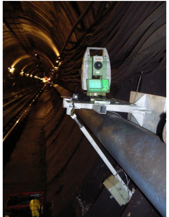
3-6. ábra Cyclops: Mérőállomás elhelyezkedése [SOLD]
