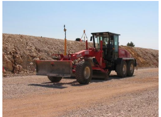
3-4. ábra 360°-os prizmával felszerelt munkagép a terepen [GEPN]
