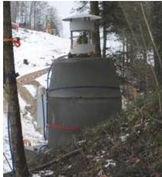
4. ábra: A mérőállomások pillérei, (Leica-Kirchtobel, 2011)
