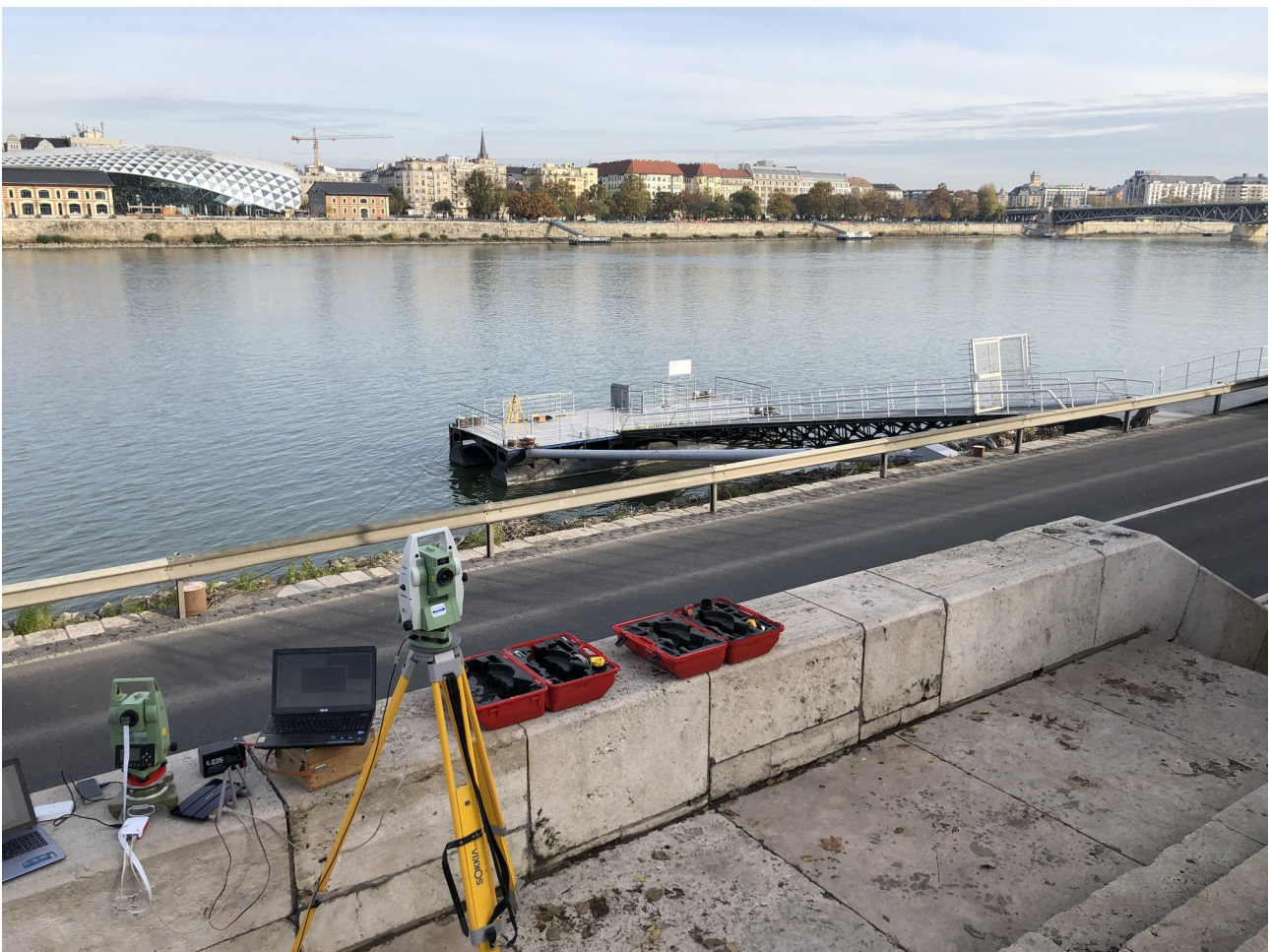
51. Ábra Monitoring rendszer és a ponton
