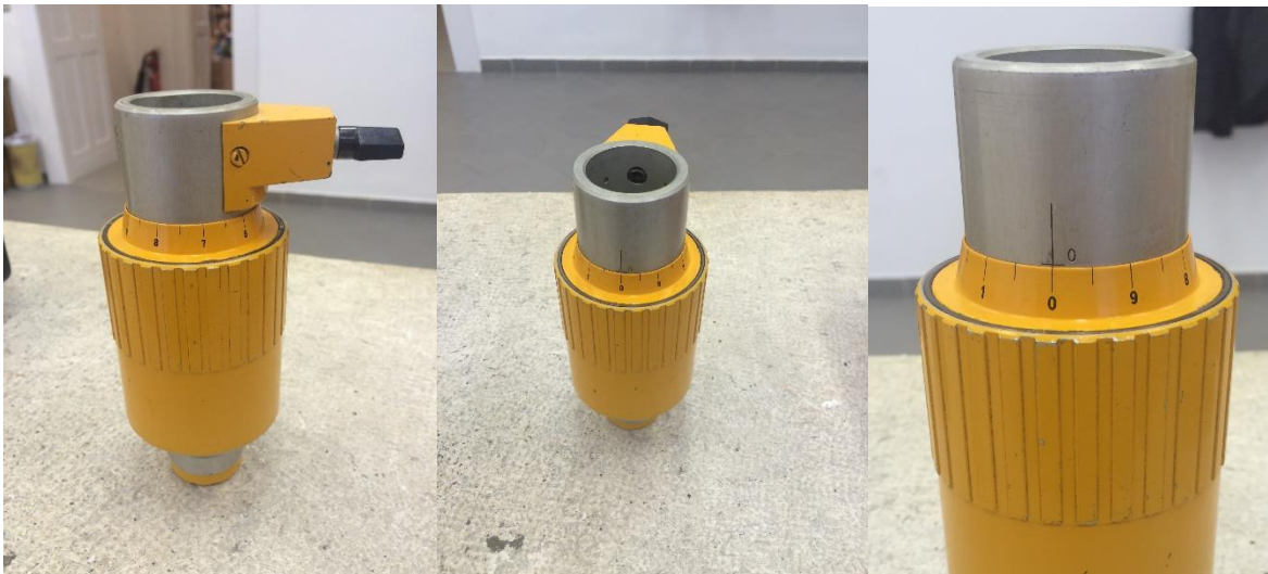
30. ábra A magassági elmozdulások létrehozásához használt eszköz
