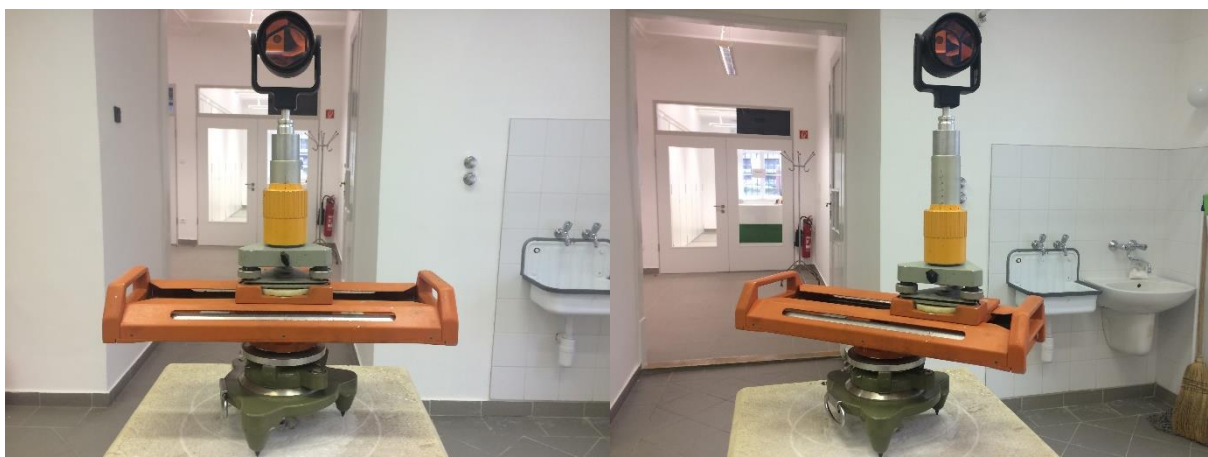
49. ábra A két képen látható mind vízszintes, mind magassági értelemben történt mozgítás
