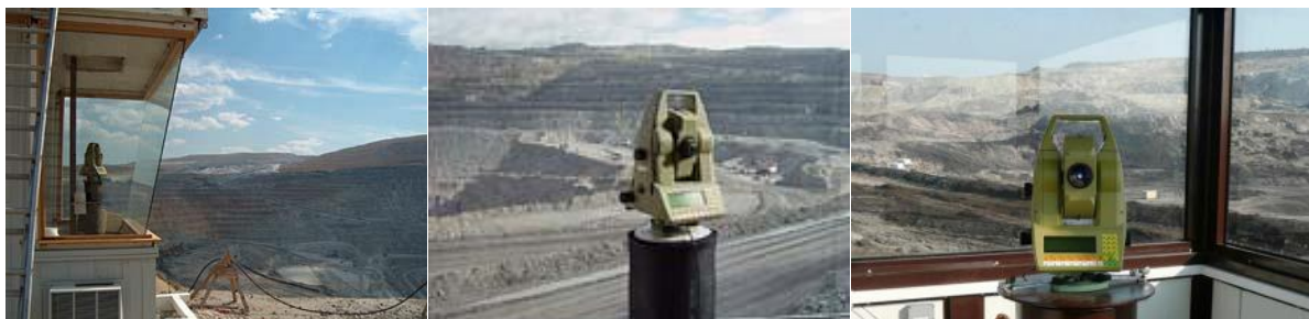
21. ábra Leica TCA1800-as monitoring rendszerek részeként telepítve, külszíni bányákban
