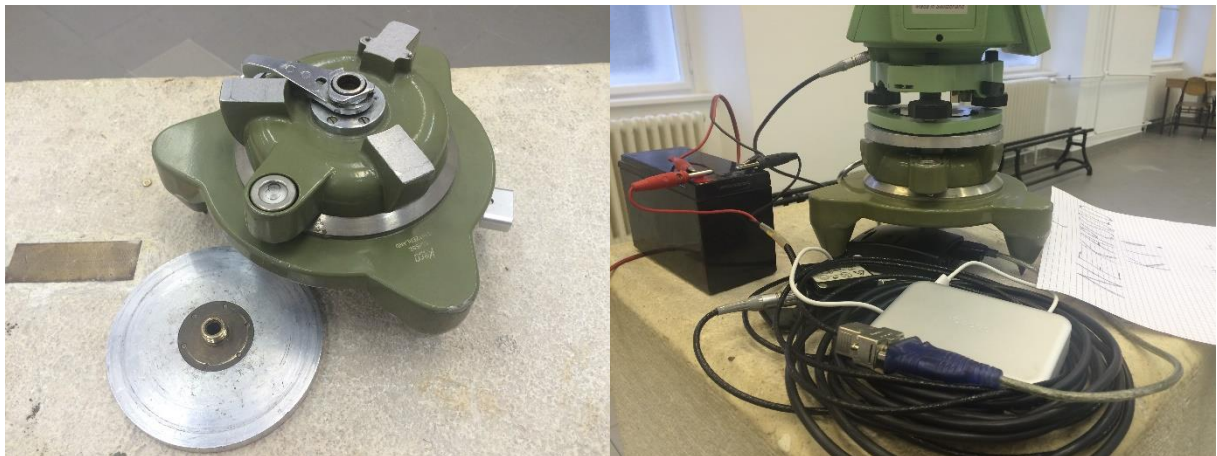
28. ábra Bal oldalt látható a Kern talp, az ezüstsínű korong az adapter a Leica műszerekhez
