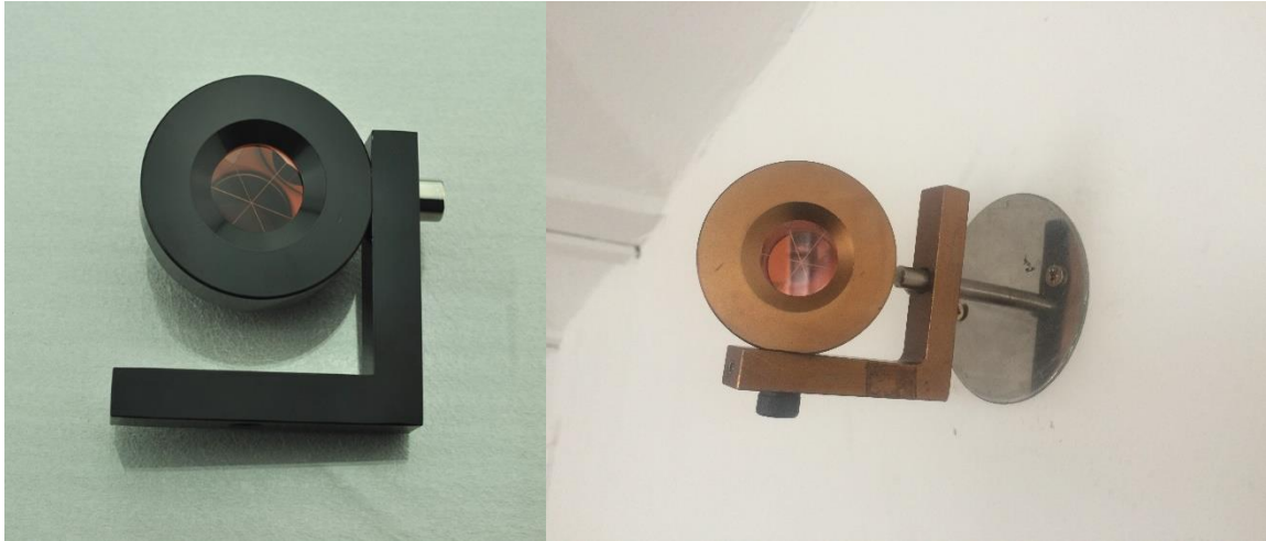
41. ábra Balra egy Leica GMP104-es látható, jobbra pedig egy, a komparátor terembe már felszerelt prizma a hozzá tartozó konzollal
