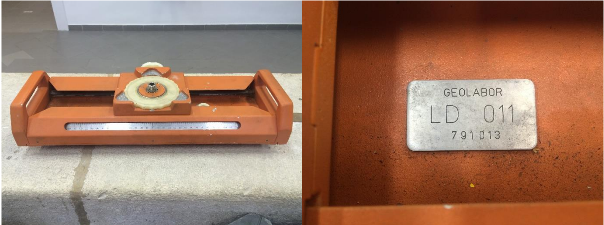
29. ábra A vízszintes elmozdulások létrehozásához használt eszköz
