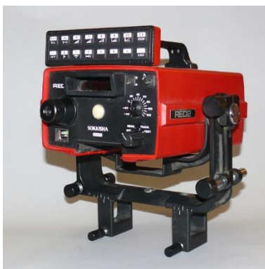
15. ábra Sokkia Red2A típusú rátét távmérő
