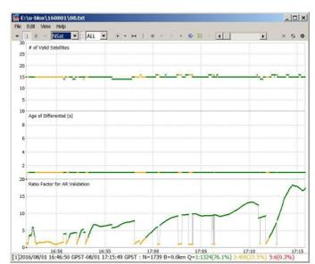
A nyers mérések rögzítése nyílt forráskódú RTKLIB programmal, párhuzamosan RTK korrekciókat vétele a GNSSNET.HU szolgáltatástól. Így centiméter pontos helymeghatározás valós időben.
